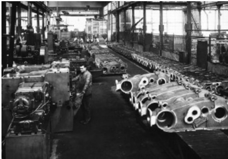
Bloc-moteur sur chaîne d'usinage.
